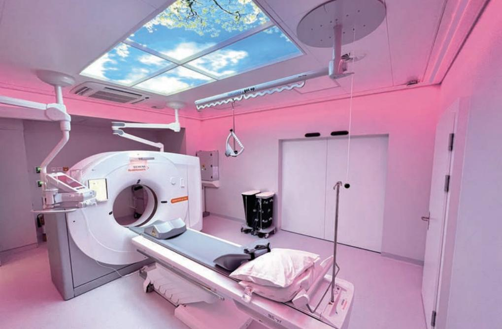
Unterstützung am CT: Das Haltesystem kann an der Decke, an der Wand oder als Bodenvariante installiert werden und erreicht fast jeden Punkt innerhalb seines Schwenkradius. Es lässt sich leicht in die gewünschte Position schwenken und dort fixieren.
